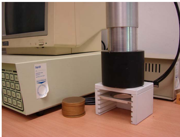
Figura 3: Detector NaI moderno, con un montaje similar al de nuestro experimento
