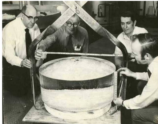
Figura 2: Detector NaI de 81cm de diámetro construido por Harshaw
