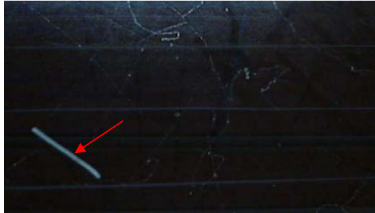
Figura 4.3- Partícula \alpha (traza oblicua) fotografiada en la cámara de IFIC.
