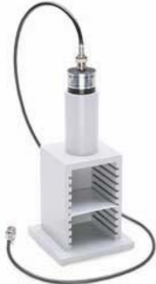
Tubo GM con castillete para fuente y absorbentes
