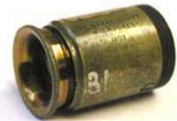
Espintariscopio: Pantalla fluorescente (ZnS)+lente
