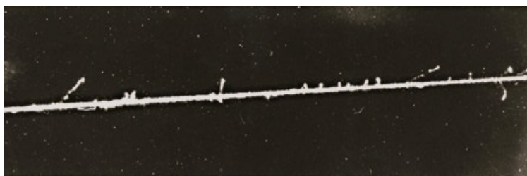
Figura 9: Traza de partícula \alpha con rayos delta (ionización secundaria)
