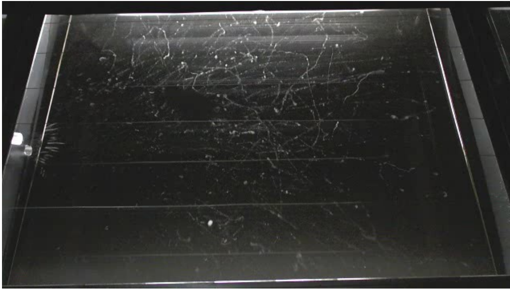
Figura 25: Radiación de una muestra de ^{226}\text{Ra} , RA-00:24,61
