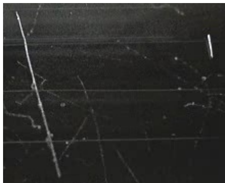
Figura 20: Protón energético proveniente de los rayos cósmicos y partícula \alpha del radón, BG - 19:10,19
