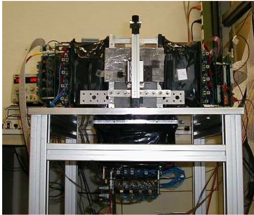
Figure 7.9: Fotografía del prototipo donde pueden verse los centelleadores a ambos lados y debajo. El detector de silicio está en el interior de la estructura metálica
