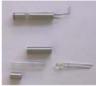
Ilustración 4: LED y cápsula metálica en donde va insertado
