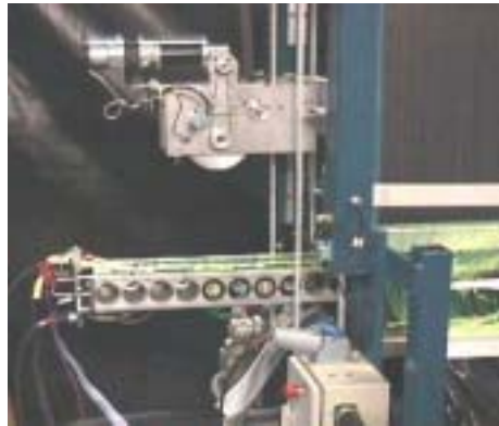
Ilustración 5: Sistema hidráulico responsable del movimiento del LED
