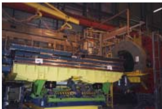
Ilustración 9: Configuración de las pruebas con haz de TileCal
