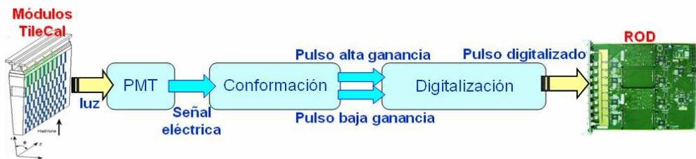
**Figura 2.** Esquema del procesado de señal en la electrónica frontal de TileCal. La luz generada por el paso de las partículas es convertida en señales eléctricas y digitalizada antes de ser enviada mediante fibra óptica a los RODs para su posterior procesado.
