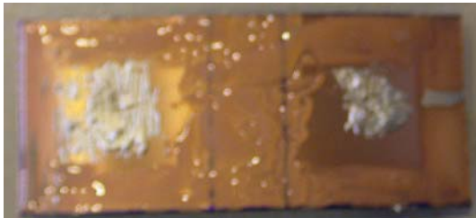
Fig. 1 Tipo 1 lengüeta con pegamento conductor
