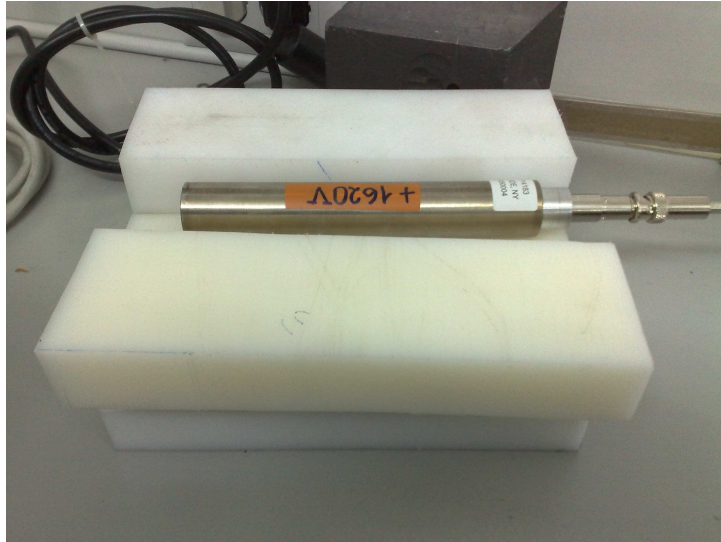
Figura 1. Cámara proporcional de ^3\text{He} y bloques de material moderador (polietileno).
